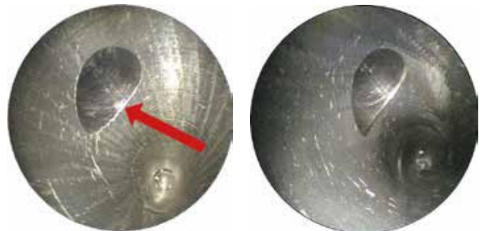
Unbearbeitete (links) und mit COFA-X-basierendem Werkzeug entgratete Bohrung (Pfeil: Restgrat). Das neue Tool entfernt den Grat mechanisch definiert und somit prozesssicher (© Heule)
